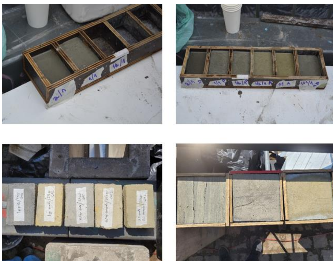
Figura 5. Produção de amostras para argamassa de reparo, utilizadas para a recomposição das áreas de substituição dos caixilhos. Foto Marco Scriboni, Ambiência, 2021.
